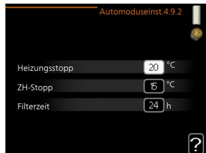
Wenn als Betriebsmodus "auto" eingestellt ist, bestimmt die Wärmepumpe ausgehend von der mittleren Außenlufttemperatur selbst, wann Start und Stopp von Zusatzheizung sowie Brauchwasserbereitung zulässig sind.
