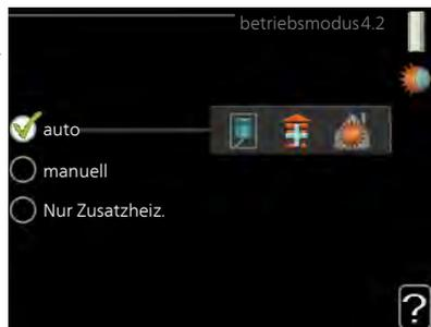
Der Betriebsmodus der Wärmepumpe wird normalerweise auf "auto" gestellt. Sie können die Wärmepumpe ebenfalls auf "Nur Zusatzheiz." stellen, wenn nur eine Zusatzheizung verwendet wird. Bei Auswahl von "manuell" können Sie die zugelassenen Funktionen selbst auswählen.
