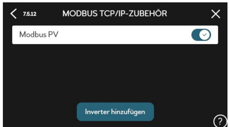
4. Geben Sie einen Namen für den Wechselrichter ein. Anschließend müssen Sie die IP-Adresse sowie den Kommunikationsport angeben. Diese Daten erhalten Sie aus dem Menü des Wechselrichters oder des Netzwerkrouterns.
